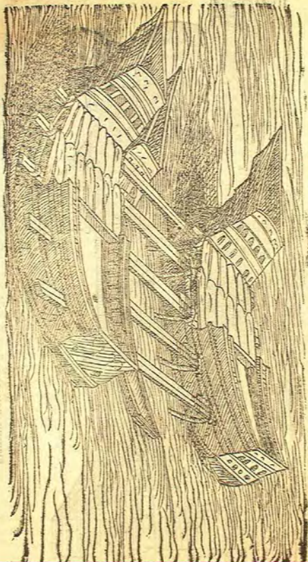
Figura esempio delle due navi piene di acqua, per sollevare la nave affondata;
